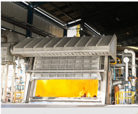
El horno de fundición, vaciado y formado de lingotes cilíndricos para extrusión.
