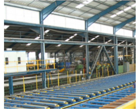
Modernas prensas de extrusión de aluminio operadas automáticamente con pullers robotizados.
